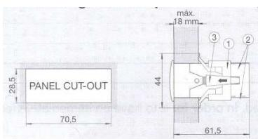
A termék rögzítéséhez helyezze a támasztó elemeket (1) a termék két oldalán lévő sínbő (2), az ábra szerint. Ügyeljen arra, hogy a gumitömítés jól illeszkedjen a kijelző rész alatt!
